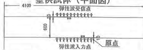
図9 壁供試体の欠陥状況および測定範囲（■：ポーラスコンクリート）
