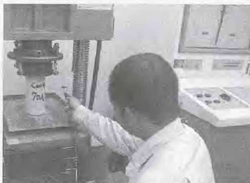
写真1 円柱供試体での接触時間測定状況
