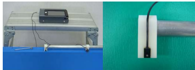
写真 2 マイクロホンによる測定状況
