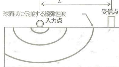
図3 縦弾性波の伝搬模式図
