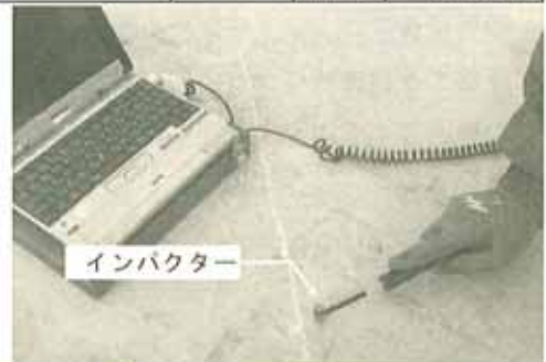
写真-1 接触時間の測定状況
