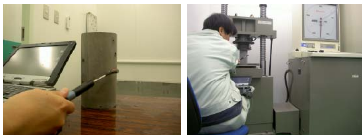
写真1 測定状況 (左: 荷重なし, 右: 荷重25kN)
