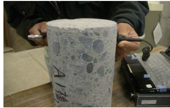
写真4 透過法によるコア試験片での弾性波速度測定状況
