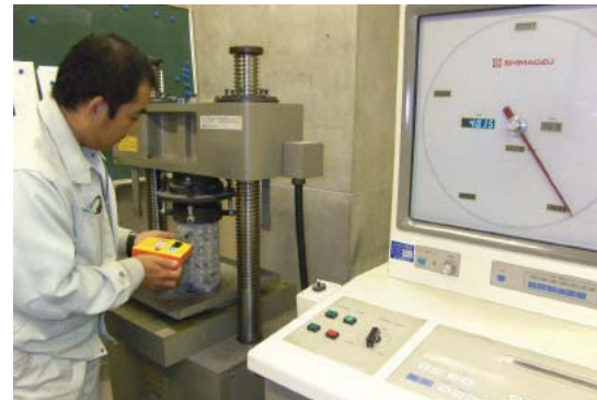
写真5 コア試験片での反発度の測定状況
