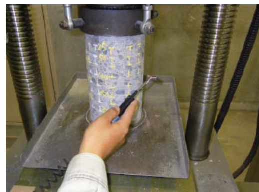
写真6 コア試験片での接触時間の測定状況
