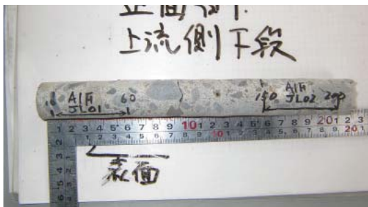
写真-2 小径コア法により採取した試験片 (φ25mm)
