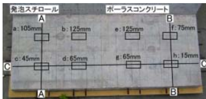
写真-2 底板の空洞位置とかぶり厚さ
