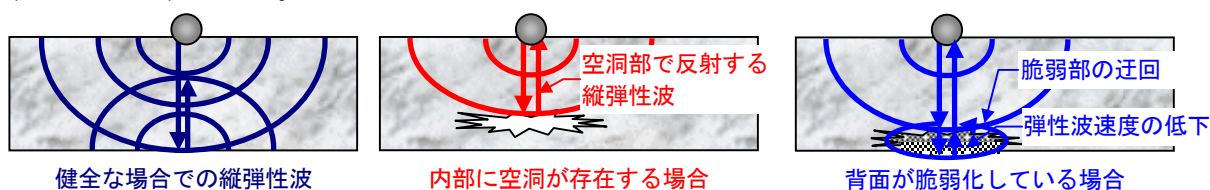
図 9 各コンクリート状況で多重反射する弾性波の模式図
