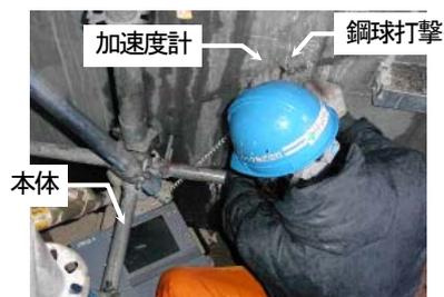
図1 衝撃弾性波法による測定装置の構成
